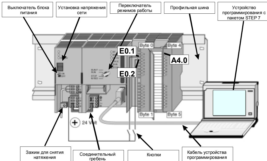
Обзор конфигурации, используемой в примере (без подключения питания SM)
